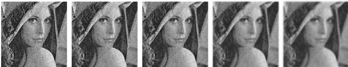
Abbildung 1: Resultat des L^2 - H^1 Entrauschens. Links das Ursprüngliche Bild, danach Rekonstruktionen für \alpha = 1, 0.5, 0.1, 0.05
