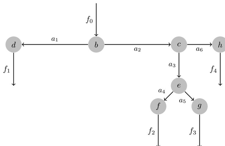
Abbildung 1: Fluss-System: Pfeile zeigen Flussrichtung der Verbindungen,  $f_0$  Einfluss und  $f_1, f_2, f_3, f_4$  Ausfluss aus dem System und  $a_i$  die Gewichte in Flussrichtung ( $-a_i$  gegen Flussrichtung).
