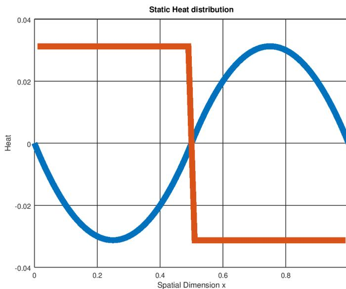
Abbildung 2: Plot der statischen Temperaturverteilung in  $x \in [0, 1]$  (Ortsdimension des Metalstabs) in Blau, die Wärmequellen (reskaliert sodass in einem Plot sichtbar) in Rot. Um Verwirrung zu vermeiden, hier steht  $F$  positiv für Kühlung und  $F$  negativ für Heizung.
